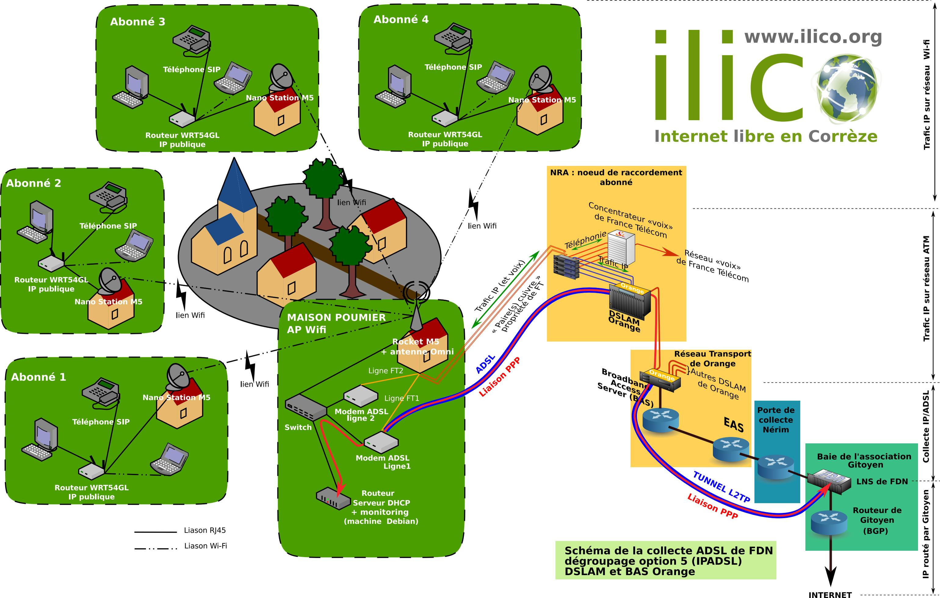
Schéma de la collecte ADSL de FDN dégroupage option 5 (IPADSL) DSLAM et BAS Orange
